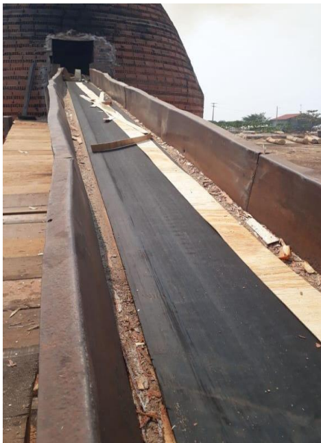
Figura 163 - Destinação final dos resíduos sólidos industriais da laminadora.
